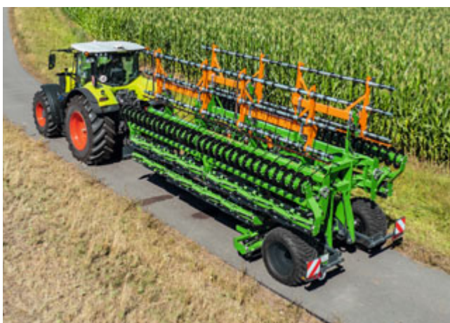
Le TopCut 12000-2T en largeur de travail 12 m est replié pour les déplacements routiers sur une largeur au transport de 3 m.
