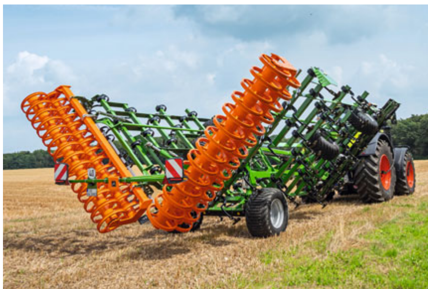
Le repliage hydraulique du compartiment de dents du Cobra est réalisé en quelques secondes
