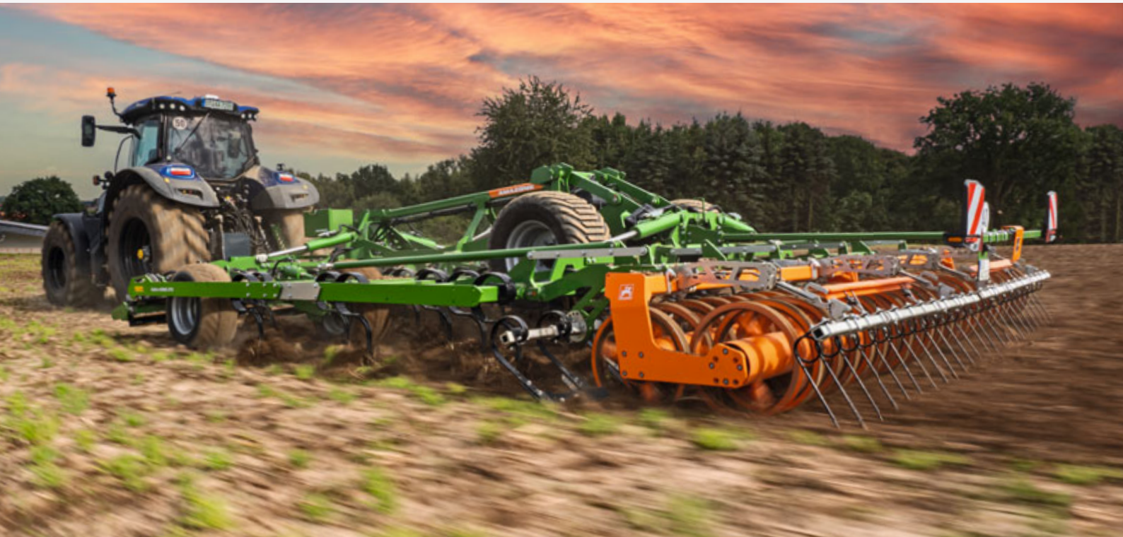
Cobra 6000-2TX avec rouleau DUW et système de herse
