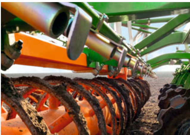
Diffuseur de semence pour une application superficielle devant le rouleau
