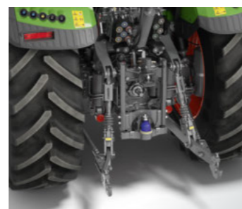
Relevage arrière avec crochets rapides et stabilisateurs latéraux (UE)
