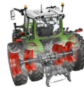
Pont arrière coulissant de 2 500 mm Roues jumelées avec moyeux duo
