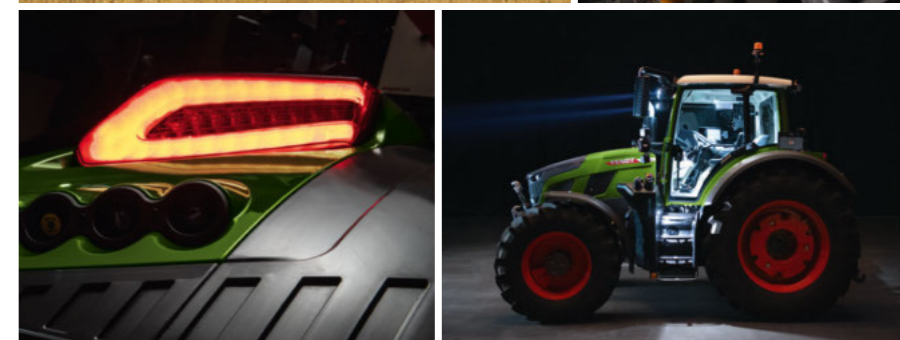
Nouveaux phares arrière à LED (compatibles CAN) avec clignotants à balayage dynamique
