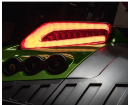
Nieuwe led-achterlichten (CAN-compatibel) met dynamisch knipperlicht
