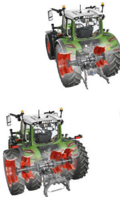
Steekas-achteras 2.500 mm dubbele wielen met duo-wielnaaf
