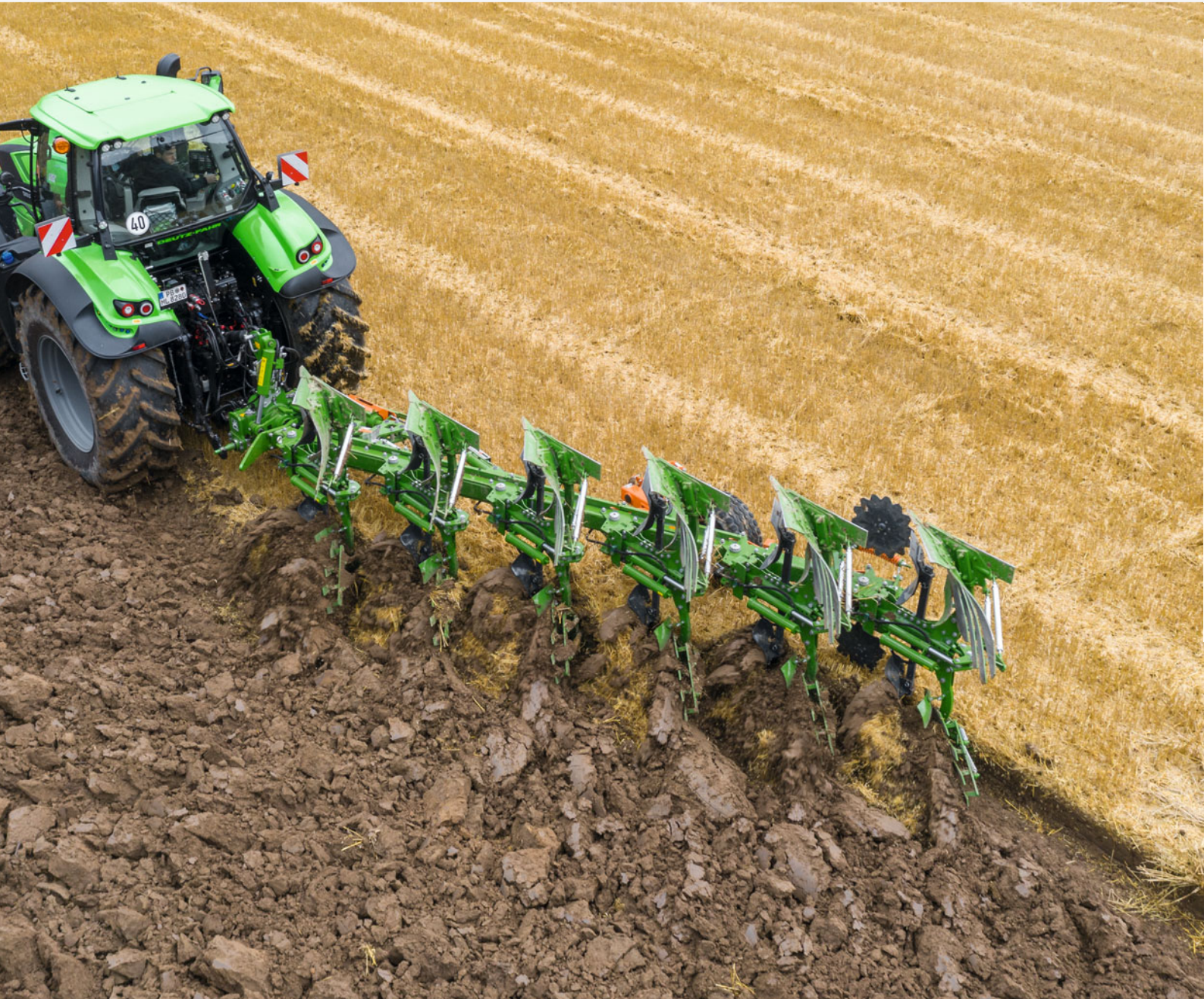
Teres 300 VS met 6 scharen voor comfortabel ploegen bij maximale werksnelheid
