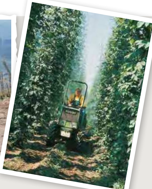
▲ De Fendt Farmer 200 V rijdt 25km/u en is speciaal ontwikkeld voor bedrijven met speciale teelten.
