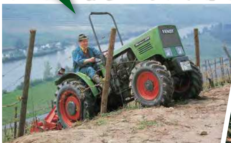
▲ De Fendt Farmer 200 V rijdt 25km/u en is speciaal ontwikkeld voor bedrijven met speciale teelten.
