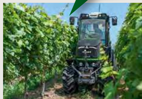
▲ Optimaal uitgerust voor gebruik in de wijngaard met drie volwaardige aanbouwmogelijkheden en een optionele luchtfilter tot beschermingscategorie 4.
