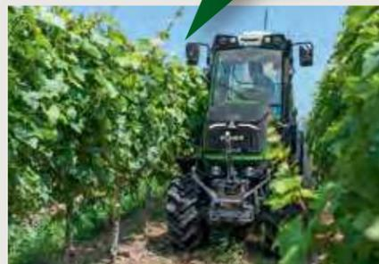
▲ Equipé de manière optimale pour une utilisation dans les vignobles, avec trois modes d'accrochage et un filtre à air jusqu'à la catégorie de protection 4, en option.
