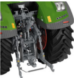
Achterhefinrichting met vanghaken en Rub Blocks (AU)
