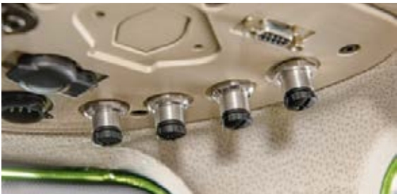
Camera-aansluitingen De 4 camera-aansluitingen (2 digitaal, 2 analoog) in het dak zorgen voor een bijzonder hoge resolutie van overgedragen beelden op de terminal.
