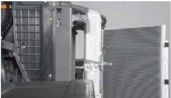
Ook de koeler is goed toegankelijk voor reiniging.
