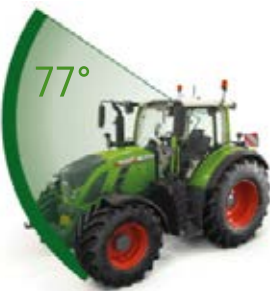
De gebogen voorruit van de VisioPlus-cabine waarborgt een ononderbroken verticaal zicht van 77 graden.
