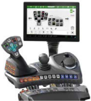
Power+, Setting 1 - Kruishendel - 1 paar wipschakelaars (lineaire module) om de hydrauliekventielen te bedienen
