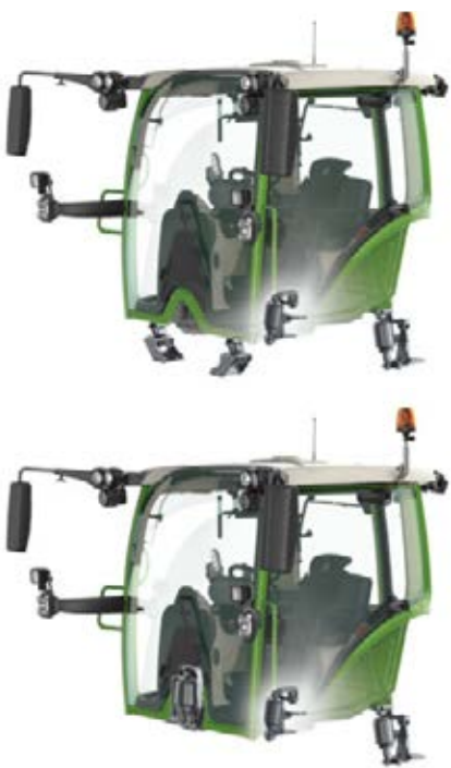
Cabinevering: keuze uit 2 uitvoeringen: pneumatisch: voor conische lagers, achter pneumatische vering; lagering op 4 punten, Comfort pneumatisch: 3 pneumatische lagers onder de cabine (centrale evenaar vóór en 2 veerpoten met drukluicht achter)
