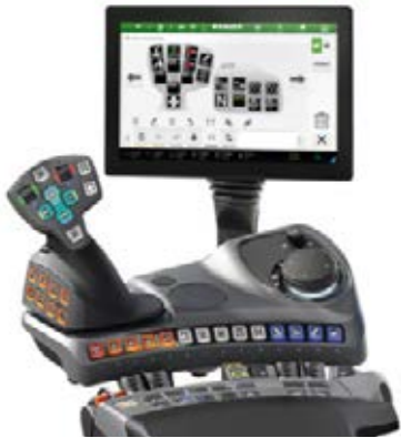
Power, Setting 1 - Zonder kruishendel - 1 paar wipschakelaars (lineaire module) om de hydrauliekventielen te bedienen
