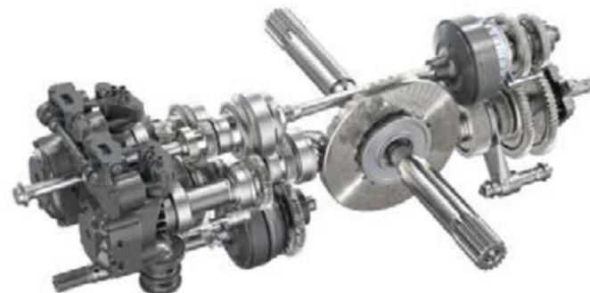
La transmission Fendt Vario est un entraînement mécano-hydrostatique à puissance partagée. Au fur et à mesure que la vitesse augmente, la part de puissance mécanique transmise à travers le train épicycloïdal augmente.
