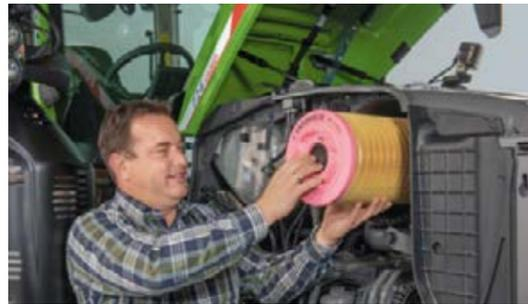
Le capot relevable et les panneaux latéraux amovibles assurent un accès aisé au compartiment moteur. Cela signifie que vous pouvez retirer le filtre à air rapidement et facilement.
