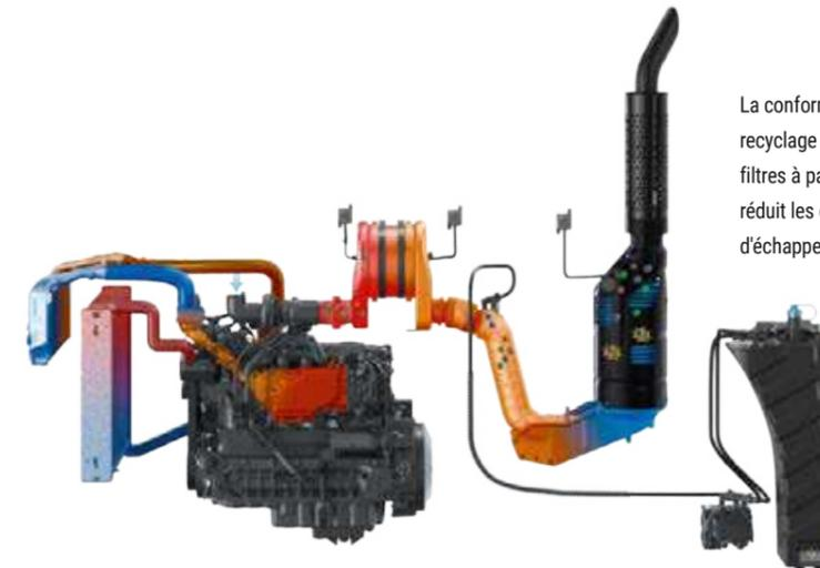
La conformité à la norme antipollution Stage V est garantie par le recyclage externe des gaz d'échappement, la technologie SCR et les filtres à particules diesel. Le recyclage externe des gaz d'échappement réduit les oxydes d'azote avant même qu'ils atteignent la ligne d'échappement, de sorte que l'AdBlue soit utilisé avec parcimonie.
