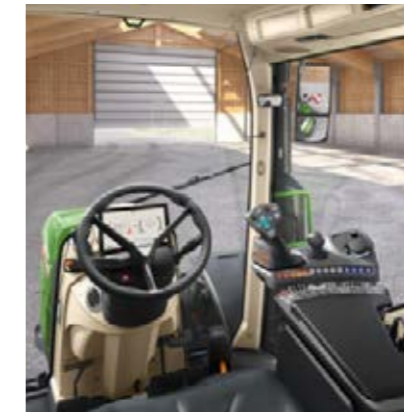
Profi Setting 1 - Levier en croix - Une paire de commandes en ligne (fingertips) pour commander les distributeurs hydrauliques
