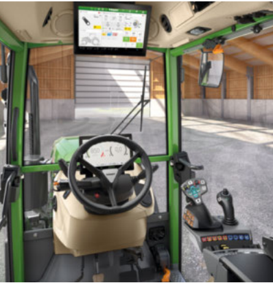
Profi Setting 2 - 3L-joystick - 2 lineaire modules (1 paar wipschakelaars) voor het bedienen van de hydrauliekventielen - 12"-terminal
