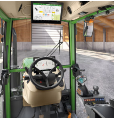
Profi+ Setting 1 - Kruishendel - 2 lineaire modules (1 paar wipschakelaars) voor het bedienen van de hydrauliekventielen - 12"-terminal
