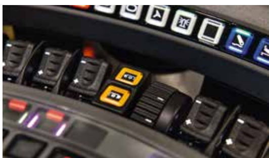
▲ Via de IOM (Individual Operation Manager) kunnen talrijke toetsen vrij met functies worden toegewezen.
