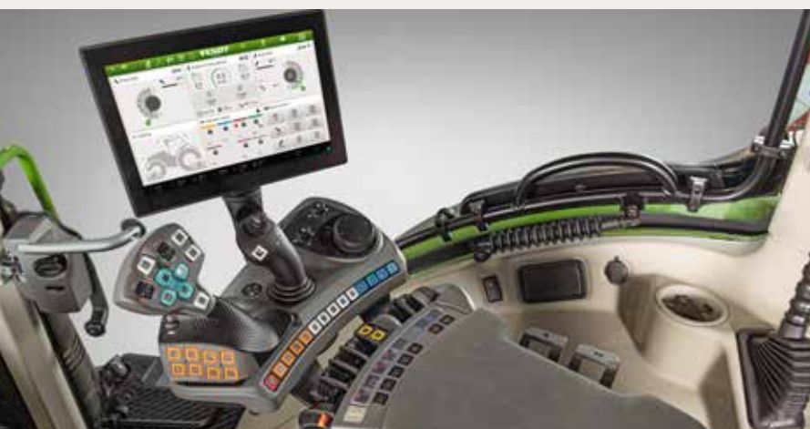
▲ De nieuwe Fendt bestuurdersplaats met multifunctionele rijhendel, 3L Joystick en draai/drukknop
