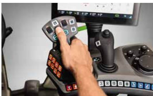
▲ De multifunctionele joystick biedt een optimale ondersteuning voor de hand. De bediening is mogelijk zonder ongemakkelijk ompakken.
