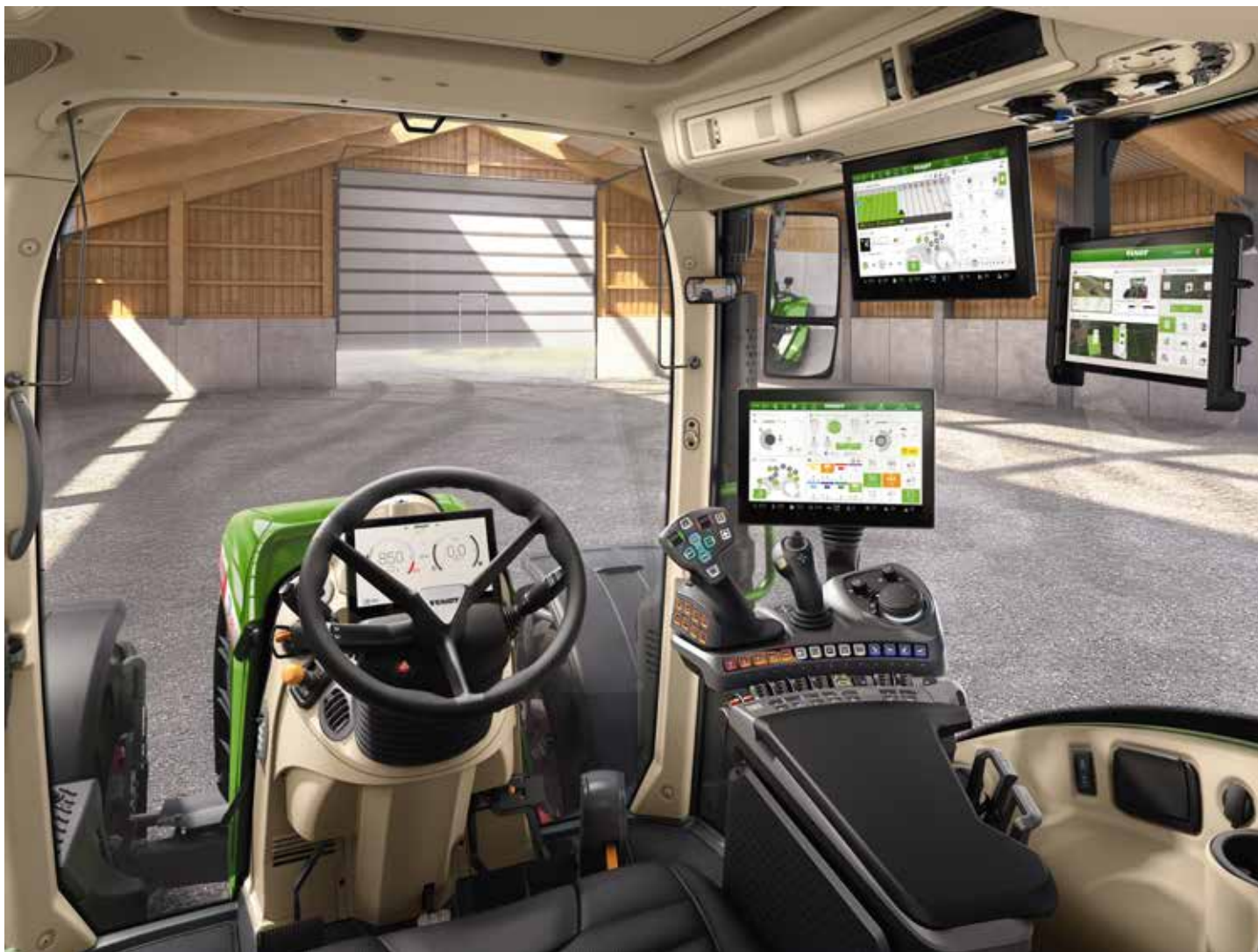
▲ De nieuwe Fendt 700 Vario werkplek: hier met de nieuwe multifunctionele joystick en 3L-joystick en drie terminals.
