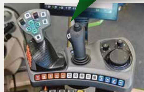
▲ De nieuwe Fendt bestuurdersplaats met multifunctionele rijhendel, 3L Joystick en draai/drukknop
