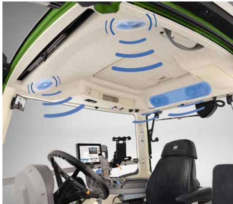
▲ Pack Infotainment : 4 haut-parleurs ou en version Premium avec un système de son 4.1 avec Subwoofer, intégré dans la Soundbar. Deux antennes, intégrées dans la fenêtre latérale à un angle de 90°, garantissent une bonne réception.
