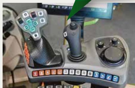
▲ Le nouveau poste de travail Fendt avec levier multifonction, joystick 3L et bouton rotatif/poussoir
