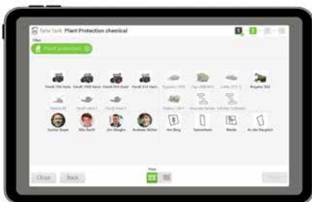
▶ Dans le Fendt Task Manager, la machine, l'outil, le conducteur et le champ sont sélectionnés pour la création d'une tâche et qui sera transférée directement vers la machine.
