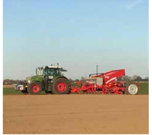
semoir permettant le semis de deux cultures différentes simultanément, par exemple des pois et du froment, semés à des profondeurs différentes et récoltés en même temps. Même si le rendement peut être légèrement diminué en cultivant de manière associée, le rendement financier quant à lui est équivalent. On peut
