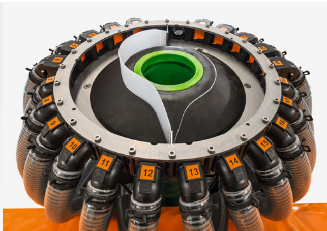
Segmentenverdeelkop met halfzijdige schakeling (geactiveerd)
