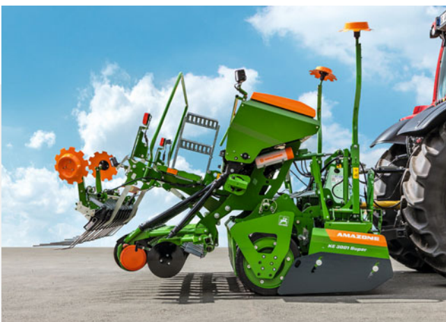
Hydraulisch heffen van de zaai-kouters bij de Cataya Special
