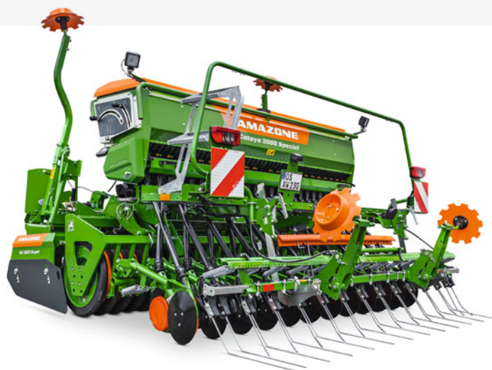
Cataya 3000 Special met 3 m werkbreedte, RoTeC-enkelvoudig schijfkouter met exakt-eg en 650 l trechterinhoud
