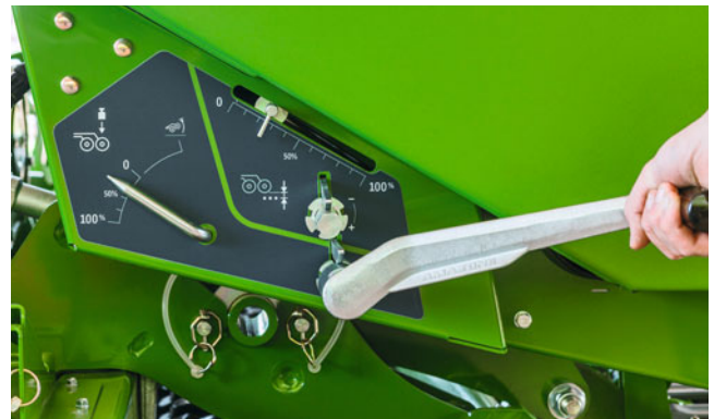
Centrale traploze mechanische verstelling van de kouterdruk met schaalverdeling bij de Cataya Super
