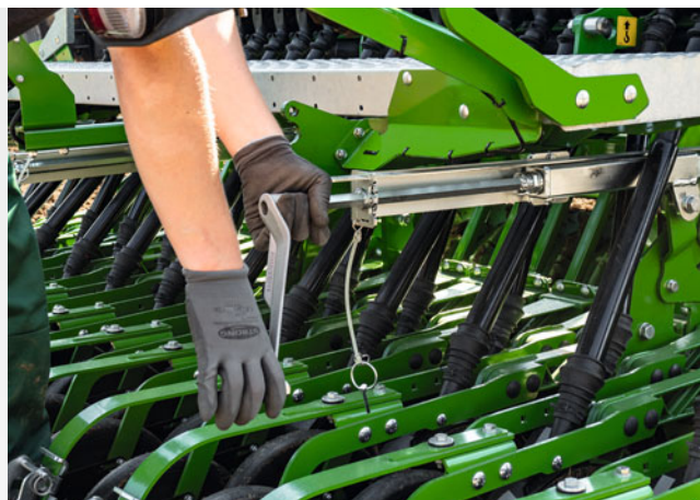
Eenvoudige instelling van de aflegdiepte rechts en links aan de achterzijde van de Cataya Special
