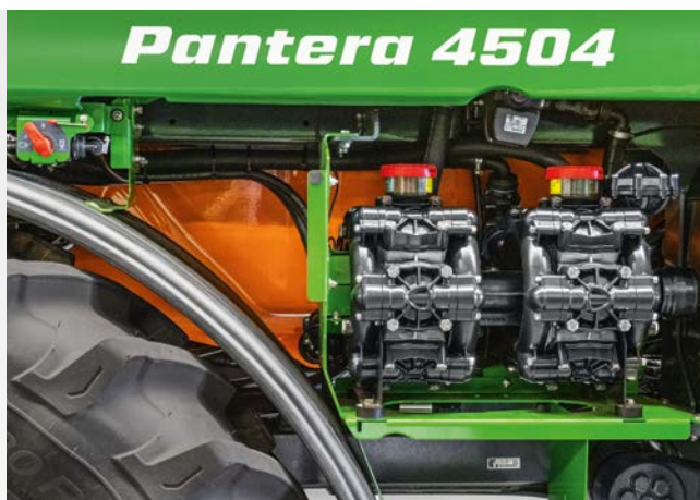
Pompsysteem aan de rechterkant van de machine
