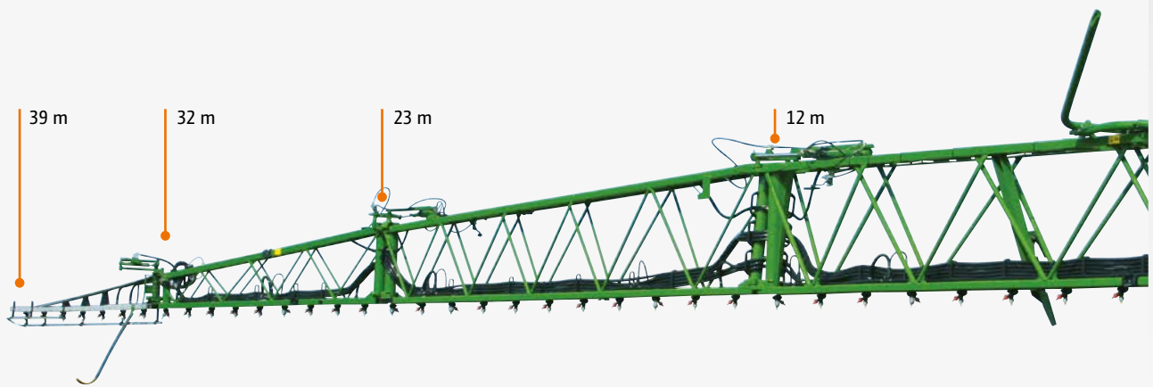
39 m Super L2 spuitboom, reduceerbaar tot 32 m, 23 m en 12 m
