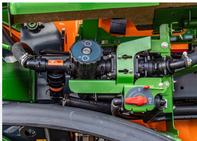
✓ HighFlow + is uitgerust met een extra, zelfreinigend drukfilter
