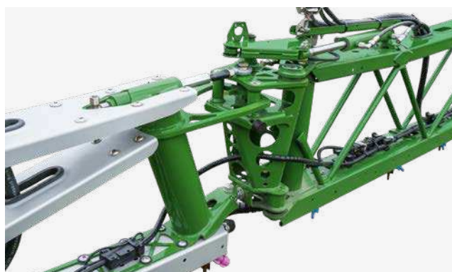
De hydraulisch voorgespannen overbelastingsbeveiliging van het topdeel (met zwaaiideurprincipe) kan naar achteren, naar voren en naar boven bewegen en zorgt voor een betrouwbaar terugzwenken en een lange levensduur.
