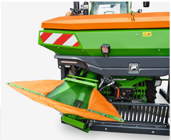
Optioneel is een vulvijzel met inklapbare dekzeiltrechter leverbaar, waardoor het vullen direct vanaf de aanhanger mogelijk is. In transportstand wordt de vulvijzel met een deksel veilig afgesloten.
