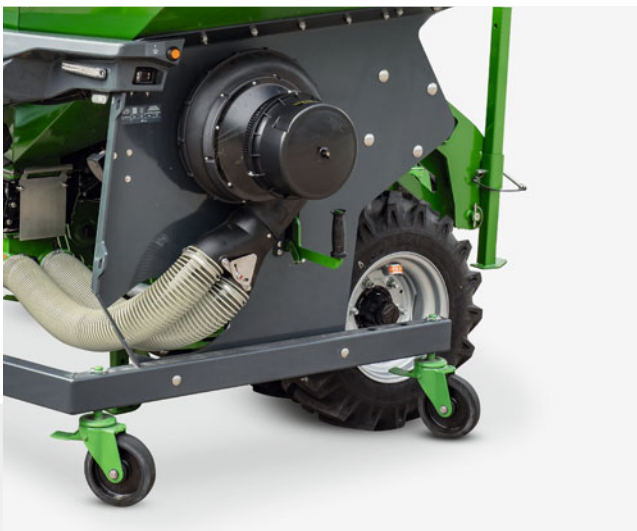
FTender met frontbandenpakker T-Pack F met optionele wegzetrollen en optionele stofafscheider
