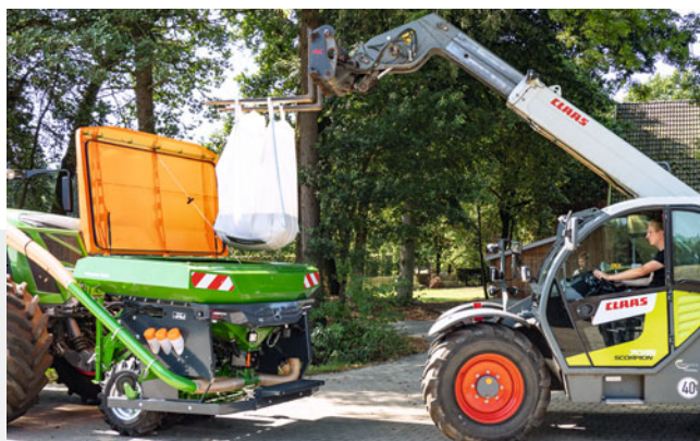
Grote tankopening van 1,10 mx 2,20 m voor snel en eenvoudig vullen van de FTender
