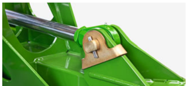
Extra geharde pennen en borging tegen verdraaien in het pro-pakket
