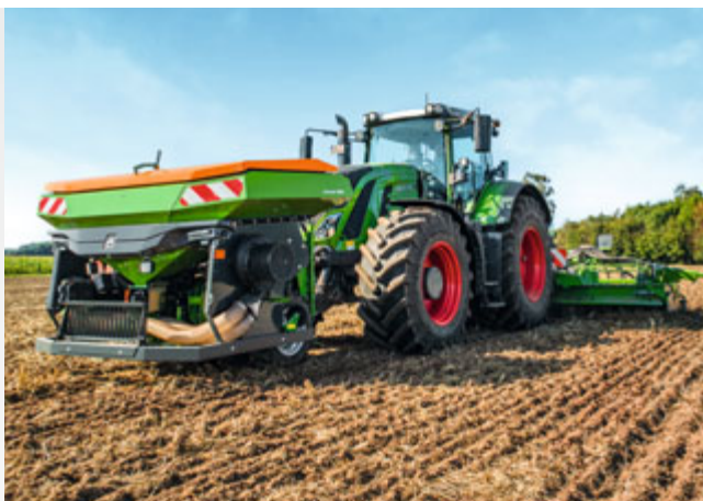
Fronttank FTender 1600 met 1.600 l tankinhoud
