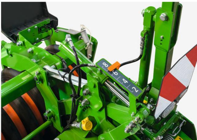
Hydraulische verstelling van de werkdiepte
