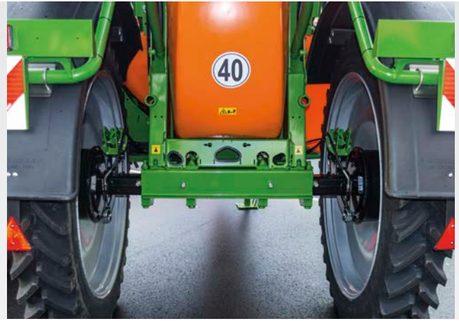
Verstelbare as met traploze spoorbreedteverstelling van 1,50 m tot 2,25 m
