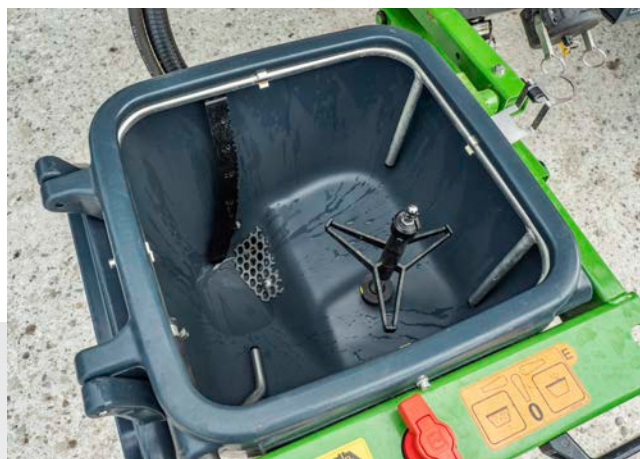
De krachtige vulmengbak zorgt voor minimale vultijden en een homogeen spuitvloei-stofmengsel
