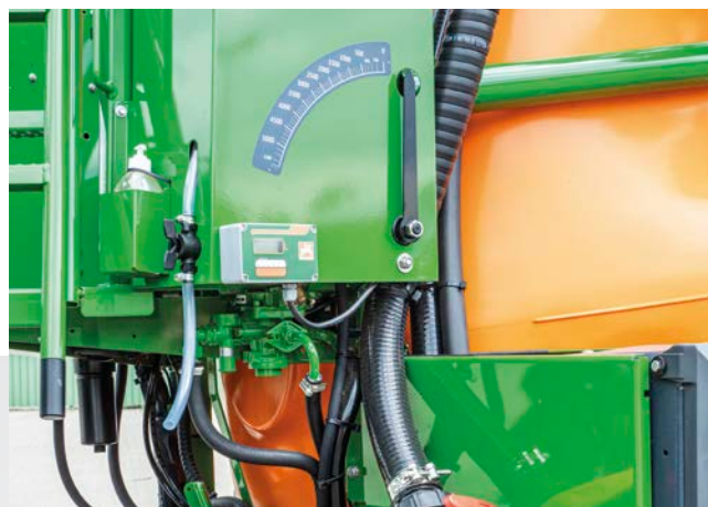
UX 5200 Special met Comfort-pakket en digitale niveau-aanduiding
