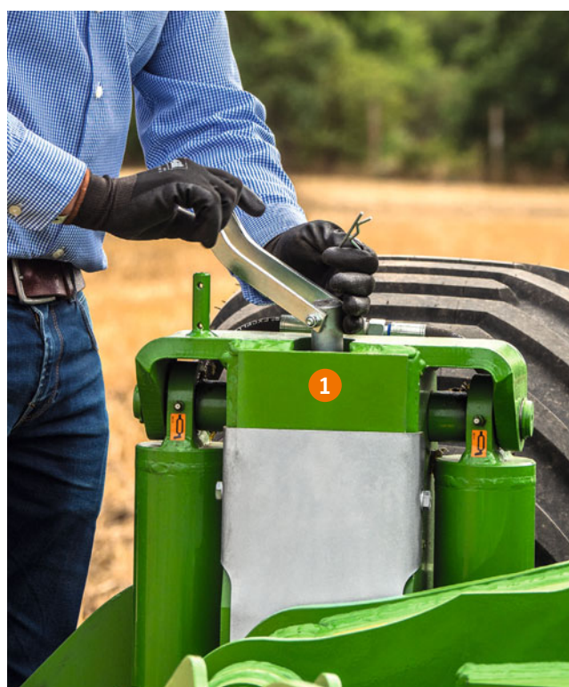
Werkdiepteverstelling op het steunwiel
