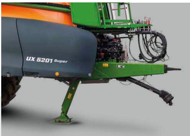
Bovenaanspanning met trekkoog en hydraulische steunpoot
