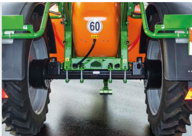
Vaste as met spoorbreedte van 1,50 m tot 2,25 m
