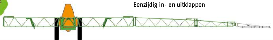
Eenzijdig in- en uitklappen (via Profi-bediening 1 of Flex-bediening)
