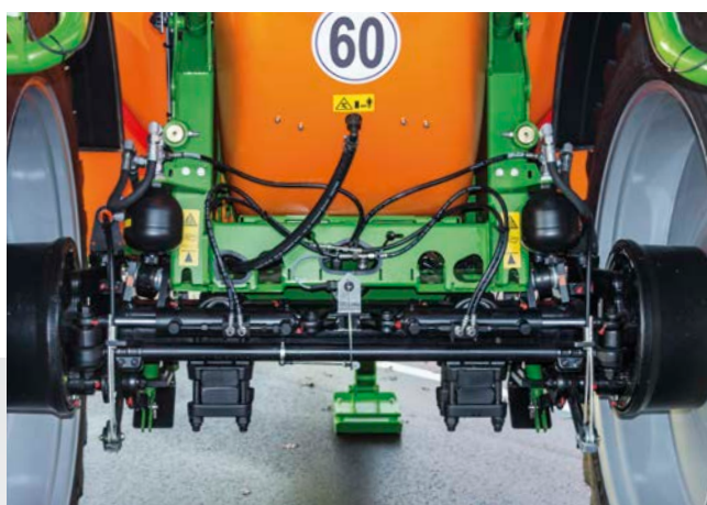
Hydropneumatisch geveerde as met AutoTrail-fuseebesturing
