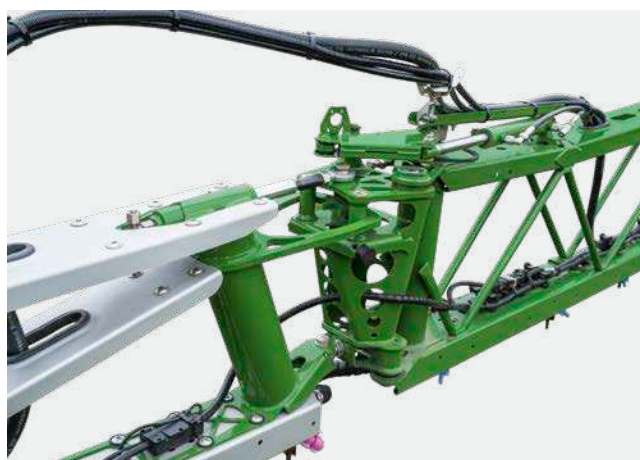
36 m Super-L3-spruitboom, te reduceren op 24 m en 12 m
