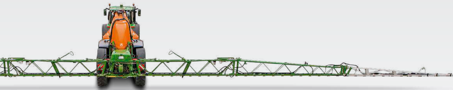
UX 11201 Super met 36-m-Super-L3-spruitboom
