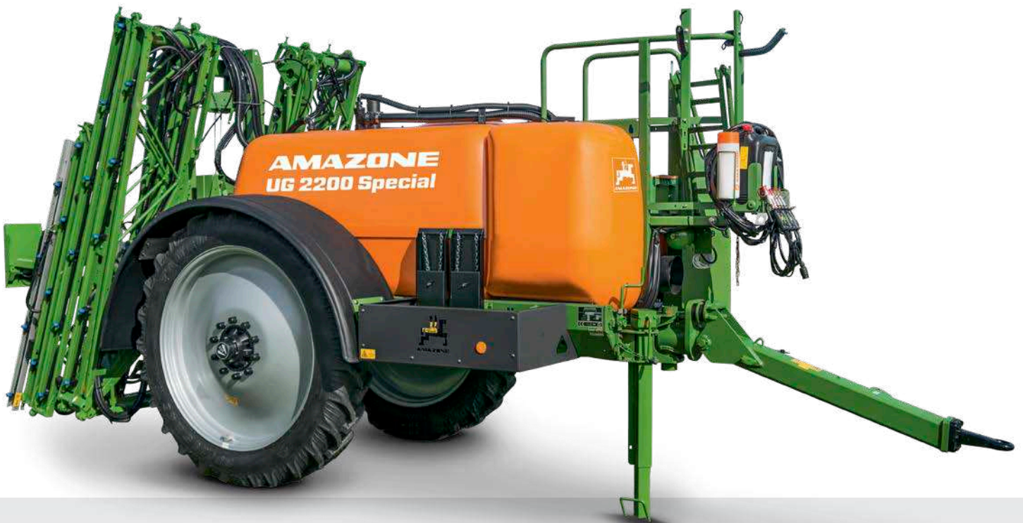
UG 2200 Special met 21-m-Super-S2-spuitboom
