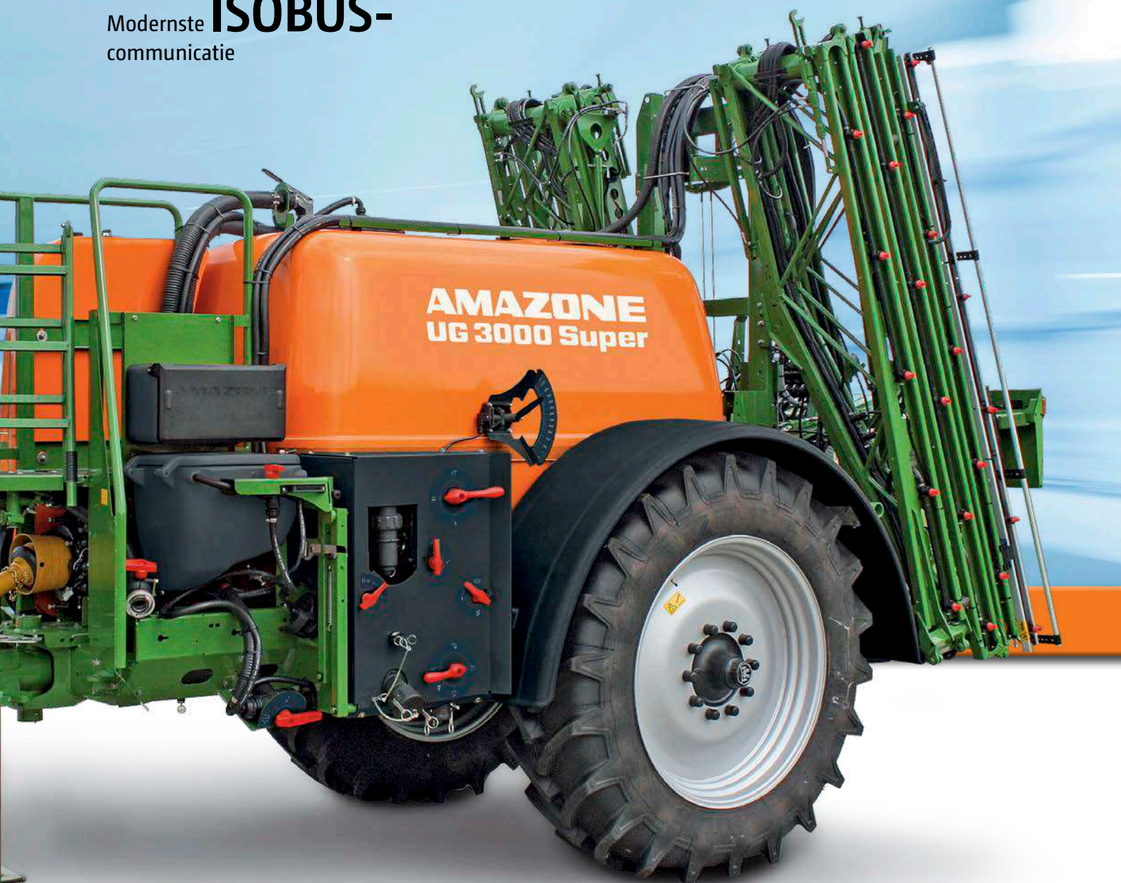
UG 3000 Super met 24-m-Super-S2-spuitboom
