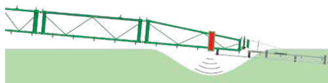
DistanceControl bij de uitrusting met 2 sensoren: Spuitboom kan bijvoorbeeld bij liggend graan in het gewas duiken
