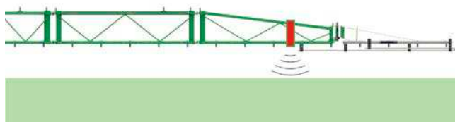
DistanceControl bij de uitrusting met 2 sensoren: Met twee sensoren: meting in het bestand
