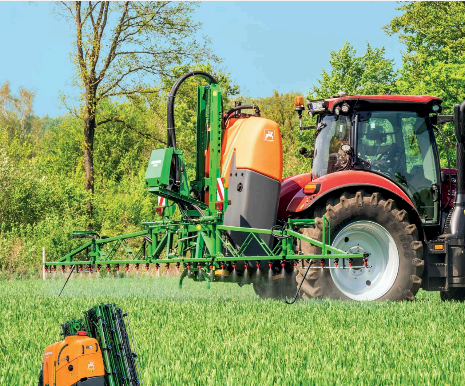
Gedragen veldspuit UF 1002 met 15 m Q-Plus spuitboom
