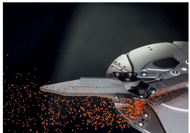
AutoTS – Instelling van de aanvoerschoep voor kantstrooien
