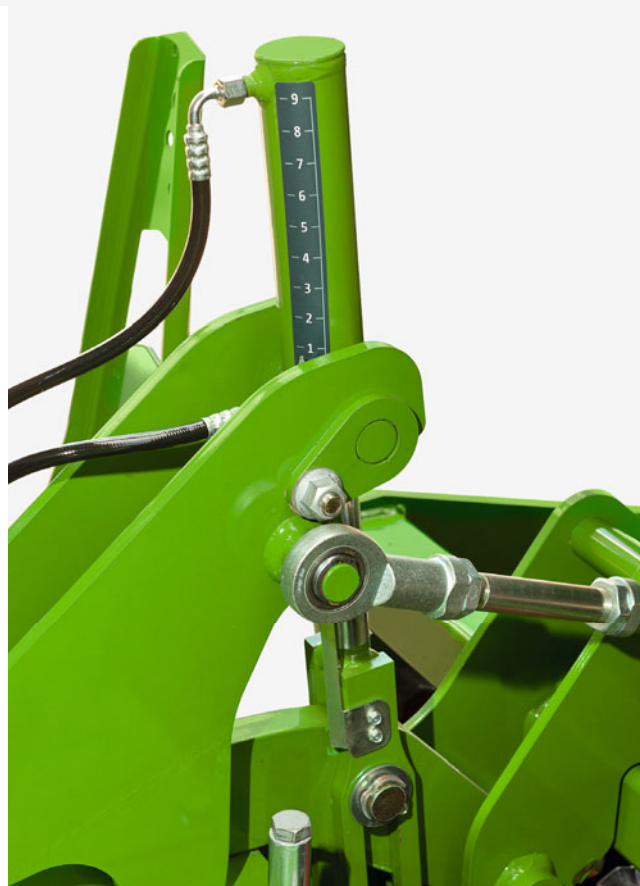
✓ Hydraulische diepteverstelling KX/KG
