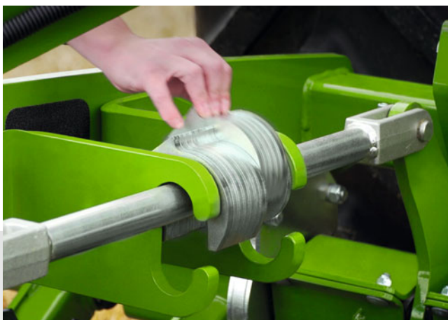
✓ Werkdiepte-instelling met afstandsringen – vlakke werkdiepte
