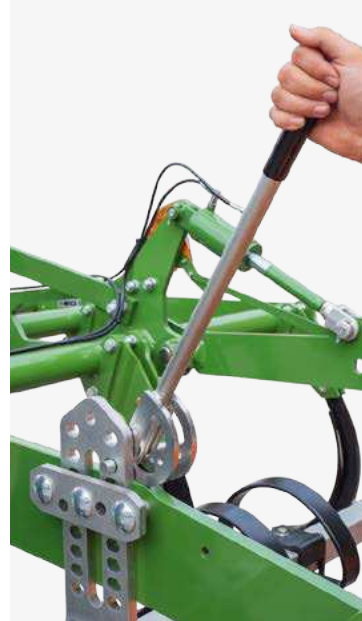
Handmatige aanpassing van de egalisatie-unit via het gatenrooster
