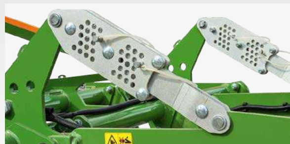
Mechanische instelling van de werkdiepte
