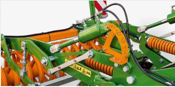
Hydraulische werkdiepte-instelling met gemakkelijk af te lezen schaal
