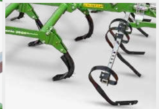
Veerstalen toestrijkers – voor eenvoudige instelling
