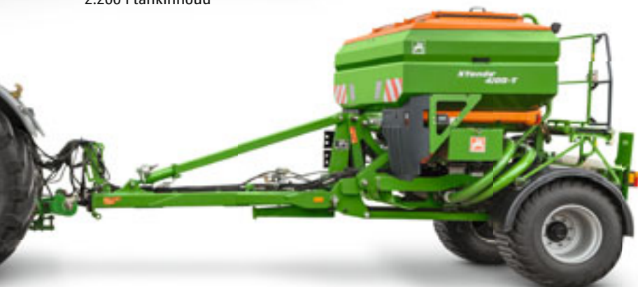
Opbouwtank XTender 2200 met 2.200 l tankinhoud
