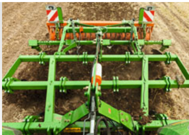
3-balkige frameconstructie van de Cenius 3003 Special
