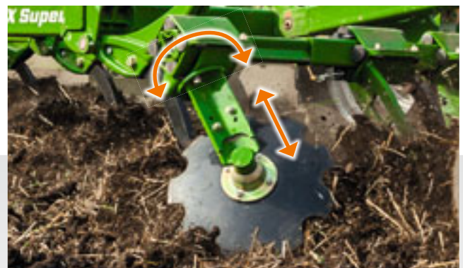
Het randelement – afzonderlijk in hoogte en hoek verstelbaar
