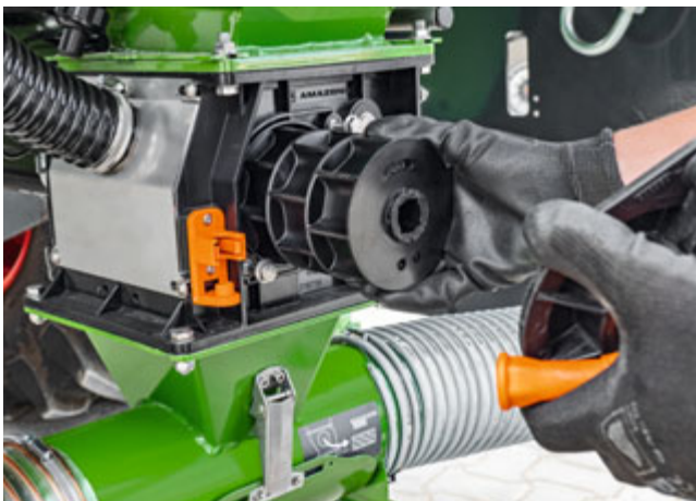
Changement simple de la bobine de dosage sur la FTender
