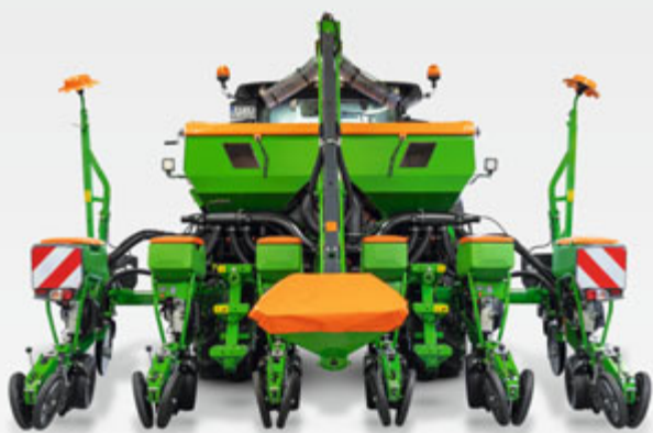
Precea 4500-2CC et son châssis télescopique avec interligne maxi
