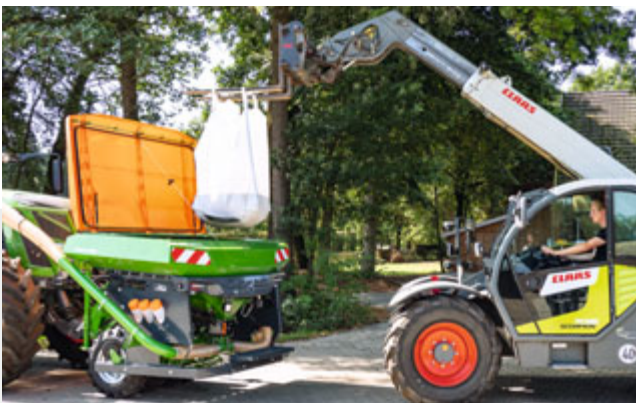
Grande ouverture de trémie de 1,1 m x 2,2 m pour un remplissage rapide et simple de la FTender
