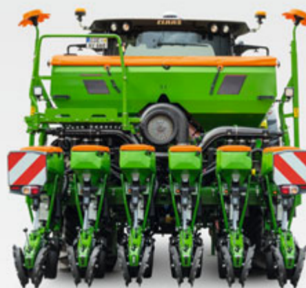
Precea 4500-2CC avec châssis télescopique variable avec réglage minimum de l'interligne
