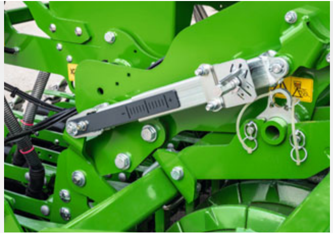
Eenvoudige instelling van de zaaidiepte aan de zijkant van de machine
