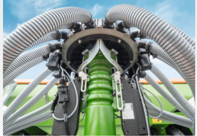
Gesegmenteerde verdeelkop met elektrische halfzijdige schakeling (niet geactiveerd)
