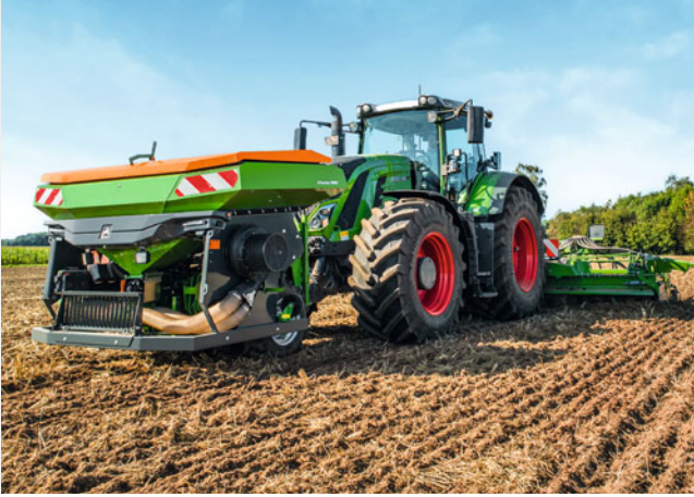
Fronttank FTender 1600 met 1.600 l tankinhoud
