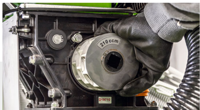
Eenvoudig verwisselen van de doseerrol
