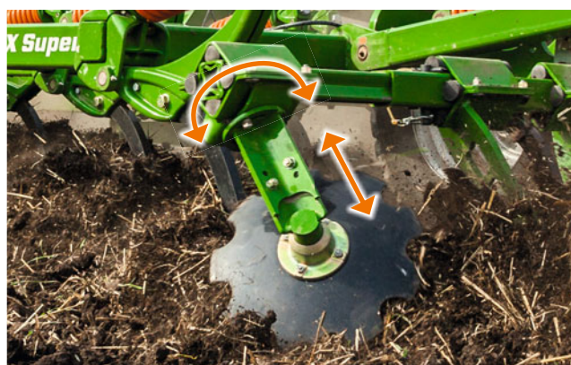
Het randelement – afzonderlijk in hoogte en hoek verstelbaar
