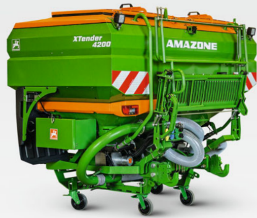
Getrokken tank XTender 4200 met 4.200 liter tankinhoud
