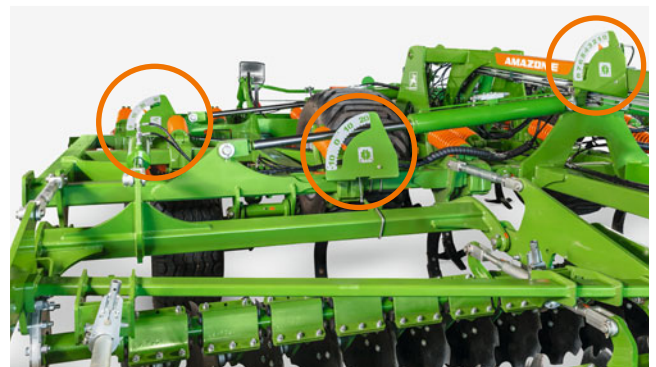
Weergave van de werkdiepte voor de drie bewerkingseenheden in één oogopslag
