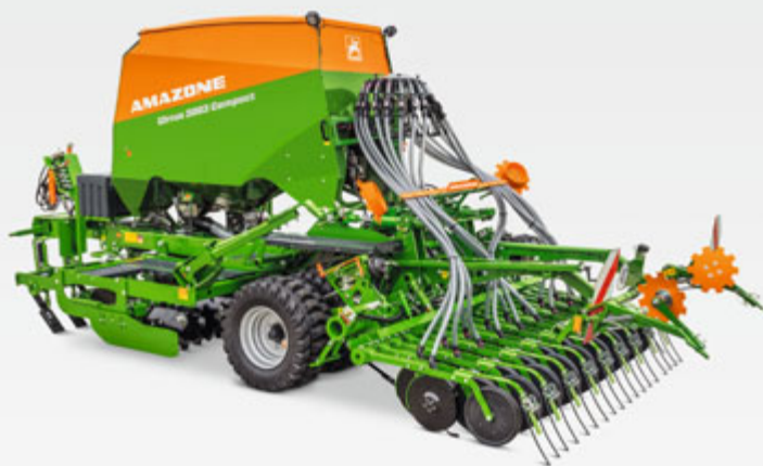
Cirrus 3003 Compact met dubbele-schijfkouter TwinTeC plus
