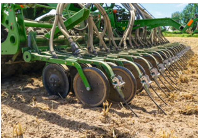
TwinTeC plus-kouter met hydraulische kouterdrukregeling
