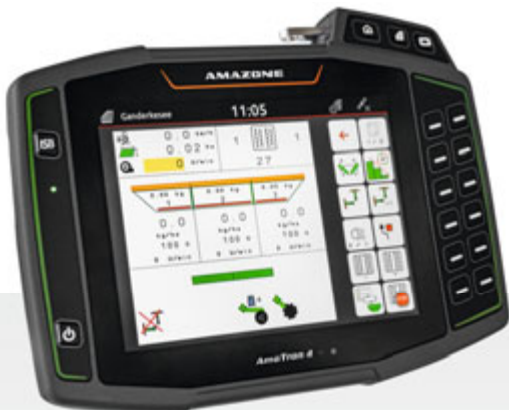
Volledig geïntegreerde bediening van de GreenDrill 501 met de ISOBUS-terminal AmaTron 4
