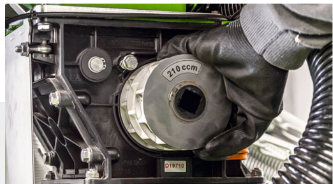
Changement facile de la bobine de dosage
