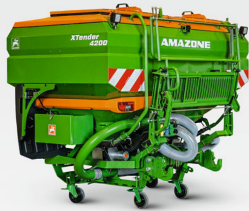
Trémie portée XTender 4200 d'une capacité de 4 200 l
