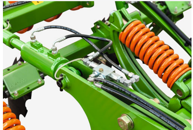
Vérin pour le réglage en profondeur des rangées de dents
