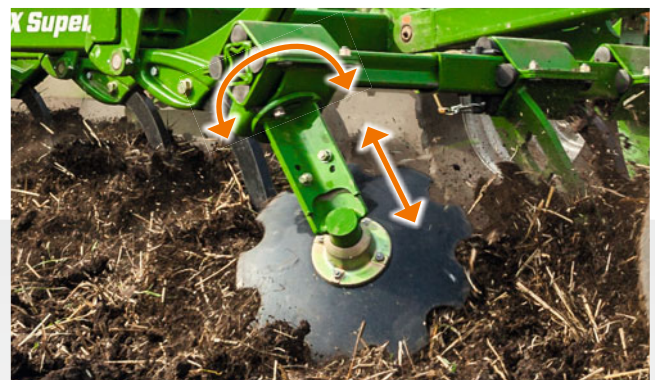
Élément de bordure – réglable séparément en hauteur et inclinaison
