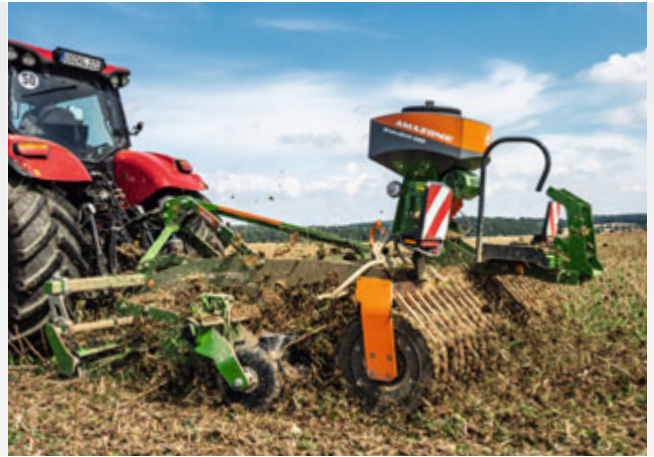
Catros XL 3003 met X-Cutter-Disc, messenwals en GreenDrill
