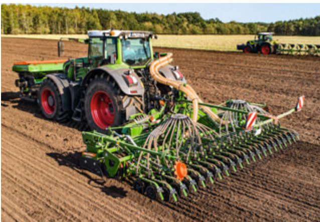
KG 6002-2 repliable avec une largeur de travail de 6 m et rampe de semis compacte Avant avec éléments semeurs TwinTeC
