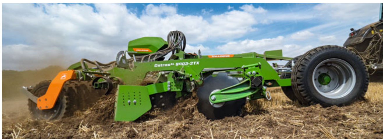
Catros XL 8003-2TX avec roues de contrôle de profondeur
