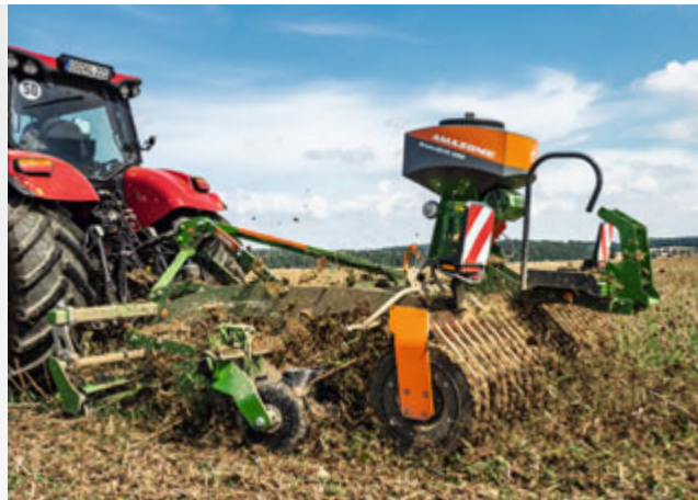
Catros XL 3003 avec disque X-Cutter, rouleau hacheur et GreenDrill
