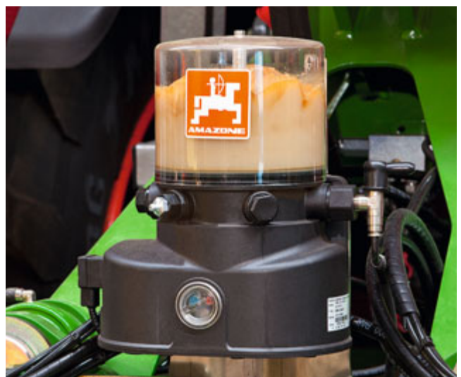
Pompe avec réservoir de stockage
