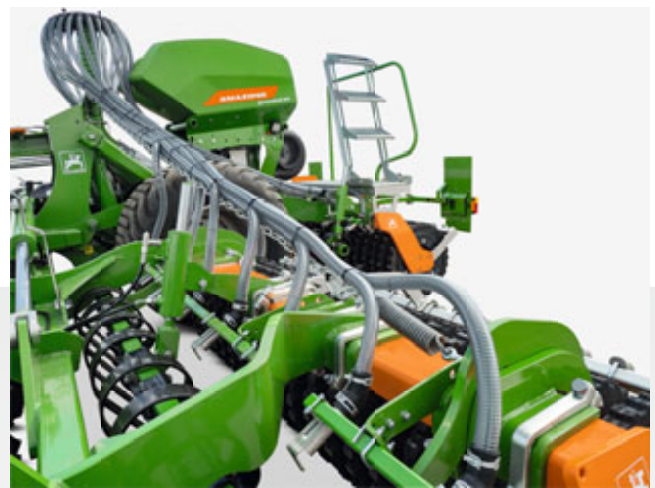
Répartition assurée grâce à la tête de distribution segmentée
