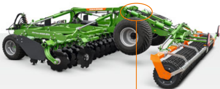
Barre supérieure hydraulique sur le Certos 6002-2TX
