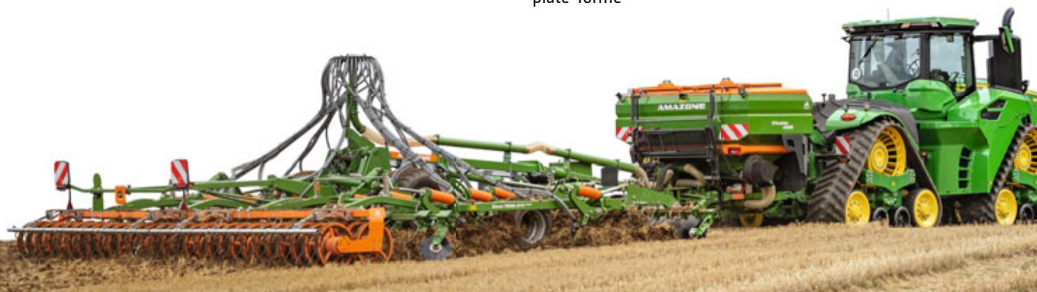
Trémie portée XTender 4200, capacité de 4 200 l avec Ceus 7000-2TX
