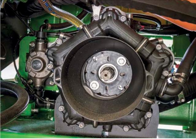
L'UF 02 peut être équipé de pompes d'une capacité de 200 l/min, 250 l/min ou 300 l/min
