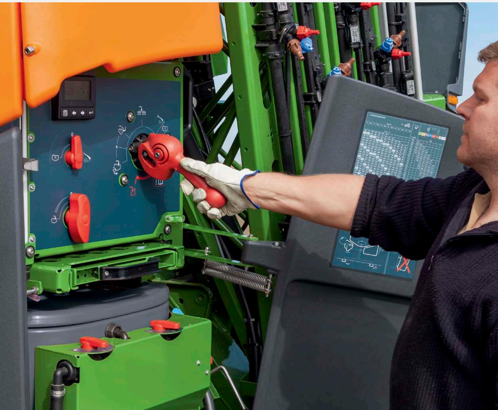
❗ « La nouvelle vanne de refoulement 7 voies est impressionnant. Il pilote toutes les fonctions côté pression. Les erreurs de pilotage sont pratiquement exclues. »
