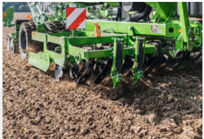
Combiné Crushboard et efface-traces de roues du tracteur monté sur le châssis du Cirrus
