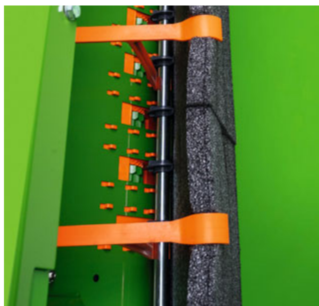
Arbre agitateur avec réducteur de trémie pour colza en option
