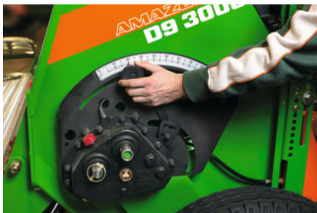
Réglage de la densité de semis directement sur la machine
