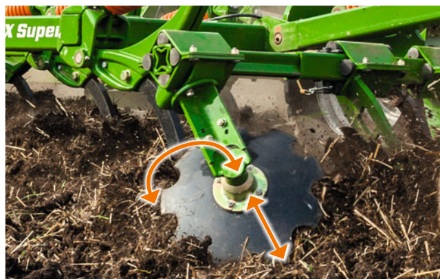
Élément de bordure – réglable séparément en hauteur et en inclinaison
