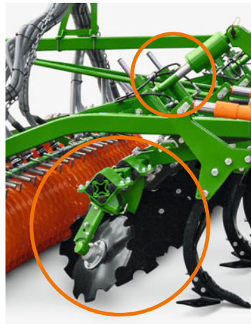
Réglage hydraulique de l'unité de nivellement
