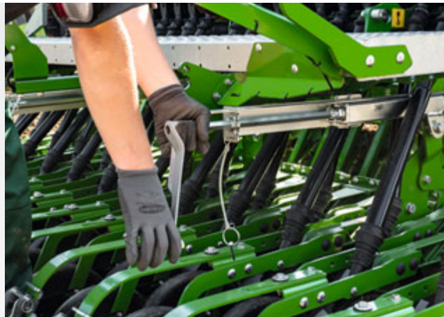
Réglage simple de la profondeur d'implantation à droite et à gauche à l'arrière du Cataya Special
