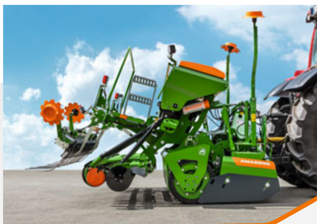
Relevage hydraulique des éléments du Cataya Special
