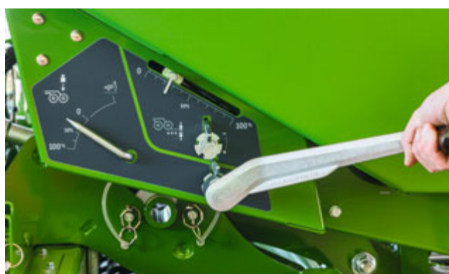
Réglage de la pression de terrage central en continu avec échelle graduée sur le Cataya Super
