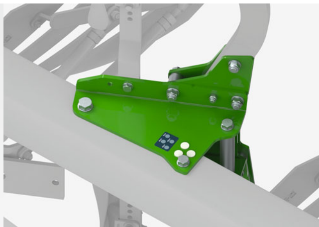
Réglage mécanique de la largeur de travail
