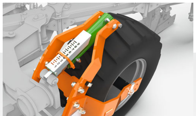
Réglage de profondeur de la roue
