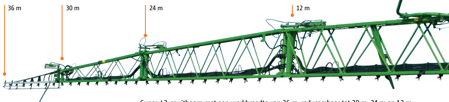
Super-L2-spuitboom met een werkbreedte van 36 m, reduceerbaar tot 30 m, 24 m en 12 m
