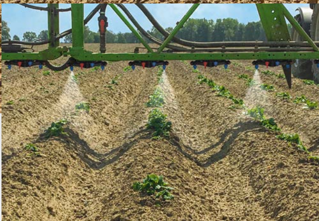
Rij-gebaseerde rijenbespuiting in aardappelbedden
