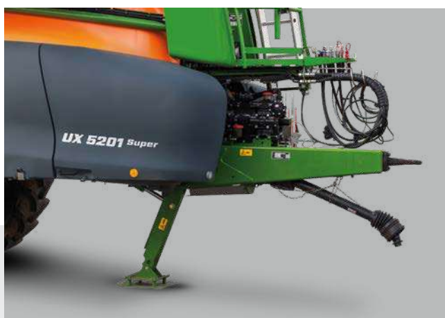
Bovenaanspanning met trekoog en hydraulische steunpoot
