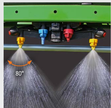
AmaSelect elektrische individuele dopschakeling met 4-voudige dophouder en een dopafstand van 50 cm of 25 cm
