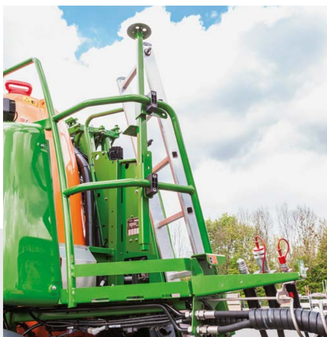
✓ Platform met ladder voor goede bereikbaarheid van de tank
