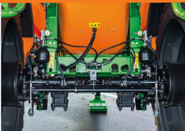
Hydropneumatische asvering met AutoTrail fusee-stuurinrichting voor de UX 4201 en UX 5201
