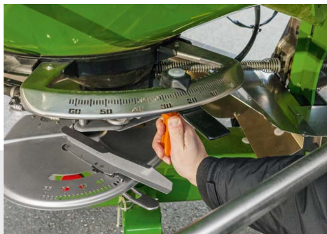
Réglage facile de la console de trappes avec grande échelle graduée
