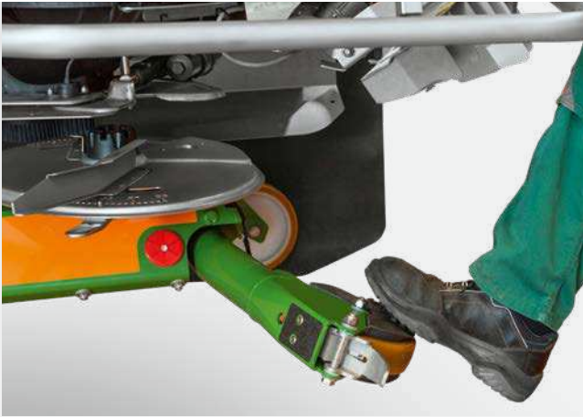
Roulettes de manutention et de remisage pour châssis Super et Ultra
