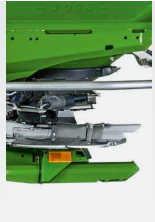
Dispositif de remisage avec patin pour châssis Super et Ultra
