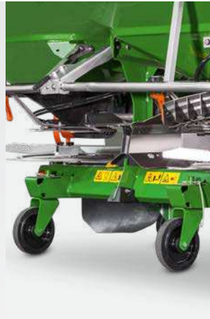
Châssis Special avec roulettes de manutention et de remisage
