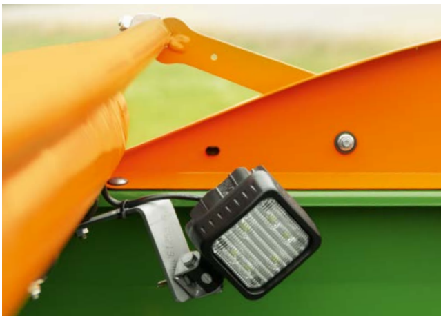
Éclairage de l'intérieur de la trémie
