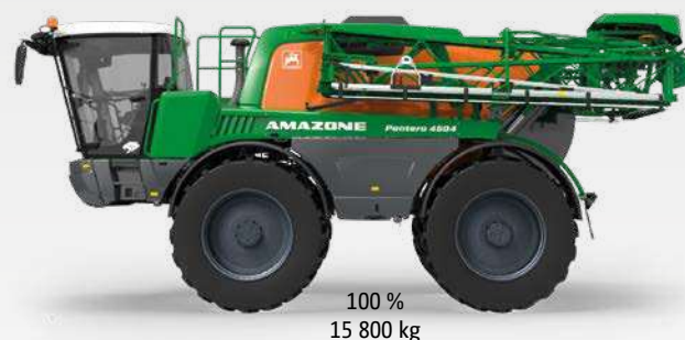
Répartition des masses, rempli et déplié
