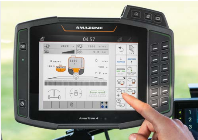
Activation de DirectInject sur le terminal AmaTron 4
