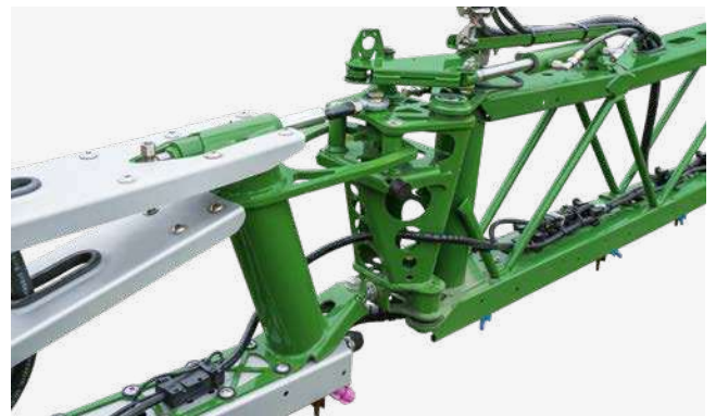
La sécurité du bras d'extrémité est précontrainte hydrauliquement. Elle assure une cinématique de déclenchement et un retour en position du bras durable avec pivotement possible vers l'arrière, l'avant et le haut.
