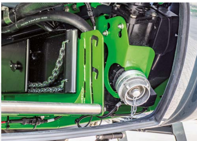
✔ Raccord de remplissage dans le casier de rangement avec arrêt automatique de remplissage
