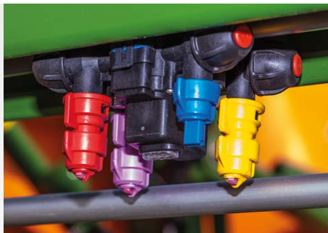
✔ Coupure électrique buse à buse AmaSelect
