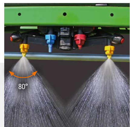
Coupure électrique de buse à buse AmaSelect avec buse quadrijet et un écart de buses de 50 cm ou 25 cm
