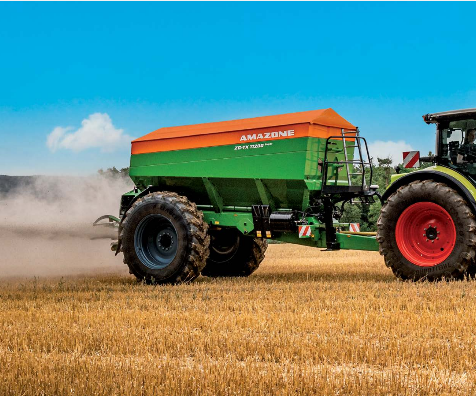
ZG-TX 11200 Super lors de l'épandage de la chaux
