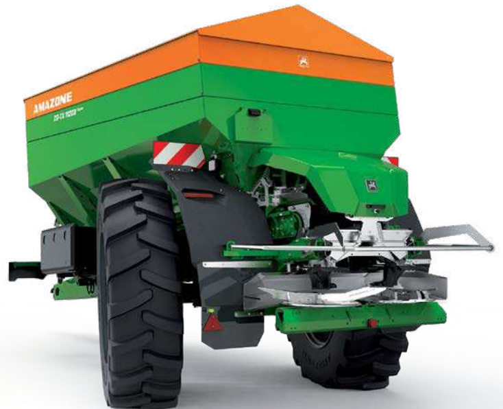
Essieu directeur avec un angle de braquage jusqu'à 20°
