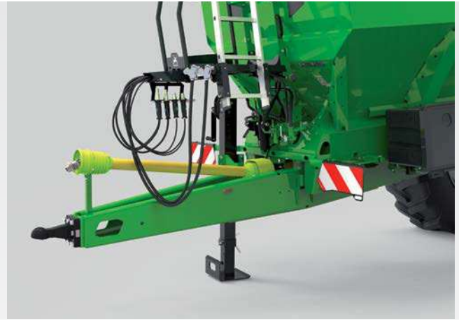
✔ Attelage en position basse avec boule d'attelage K80
