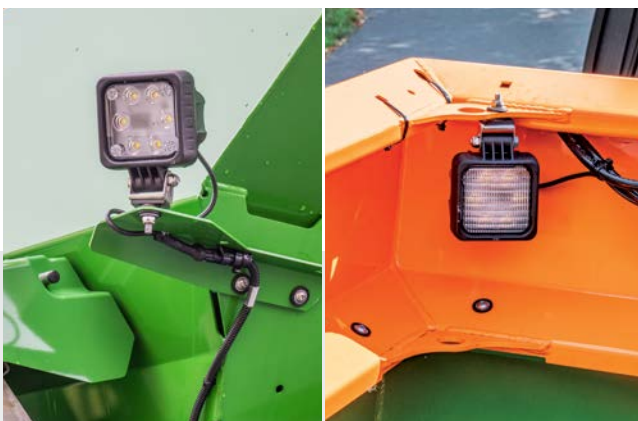
Éclairage de travail à l'extérieur et à l'intérieur de la trémie
