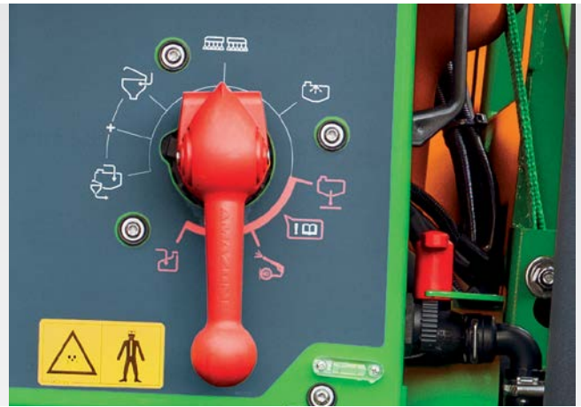
✔ Commande simple par le biais d'une vanne de refoulement 7 voies
