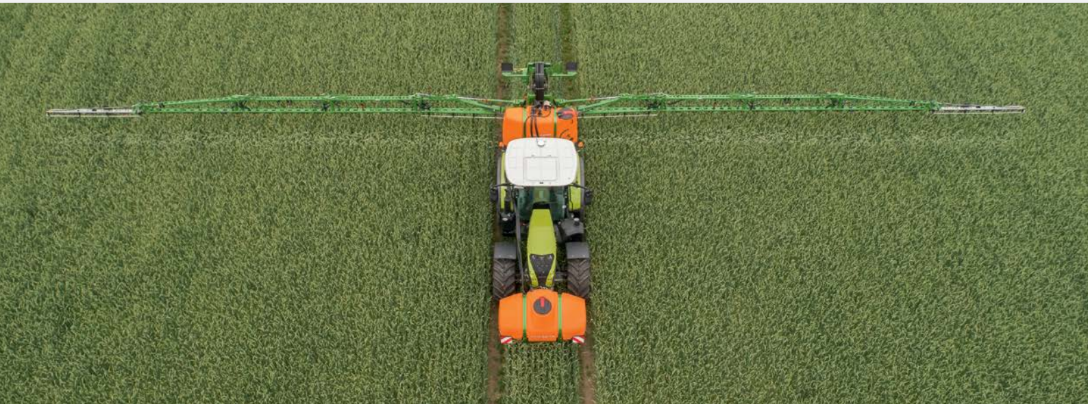
UF 2002 avec rampe Super-S2, largeur de travail 30 m et cuve frontale FT 1502
