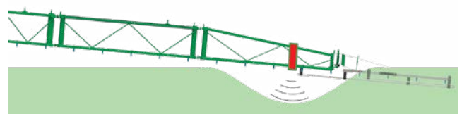
DistanceControl avec équipement deux capteurs : la rampe peut par exemple plonger dans la culture si les céréales sont versées
