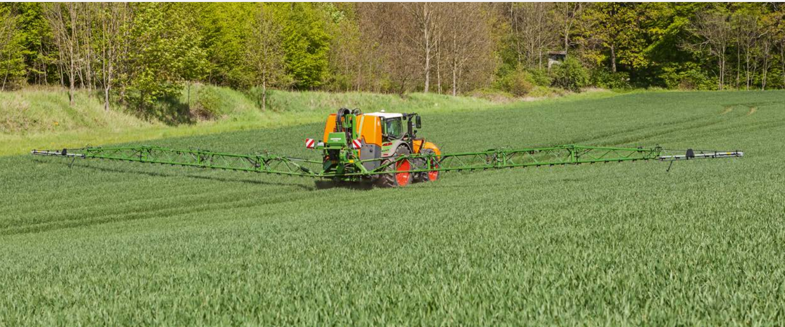
Pulvérisateur porté UF 2002 avec ContourControl pour un pilotage de rampe entièrement automatique
