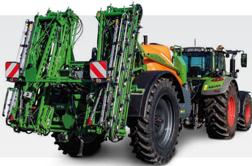
UX 4200 Special avec rampe Super-S2, largeur de travail 27 m
