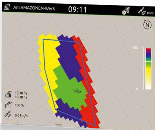
Représentation d'une carte de modulation sur l'AmaTron 4
