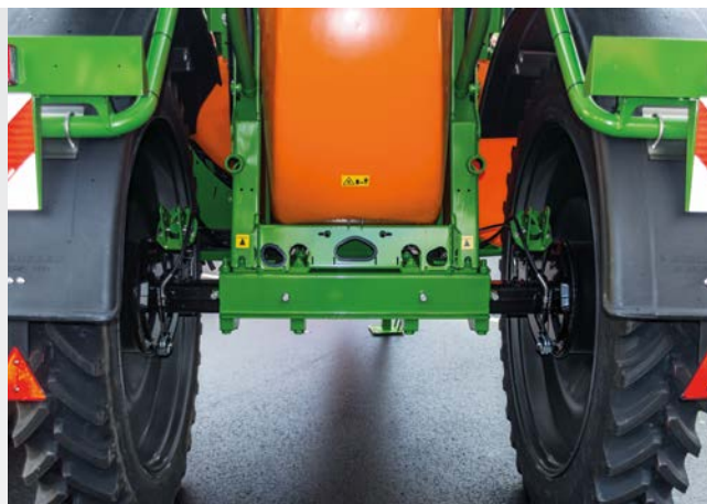
Essieu réglable avec réglage de la voie en continu de 1,50 m à 2,25 m
