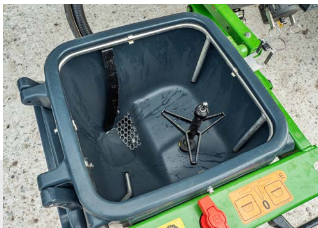
Le puissant bac incorporeur assure des temps de remplissage courts et un mélange homogène de la bouillie
