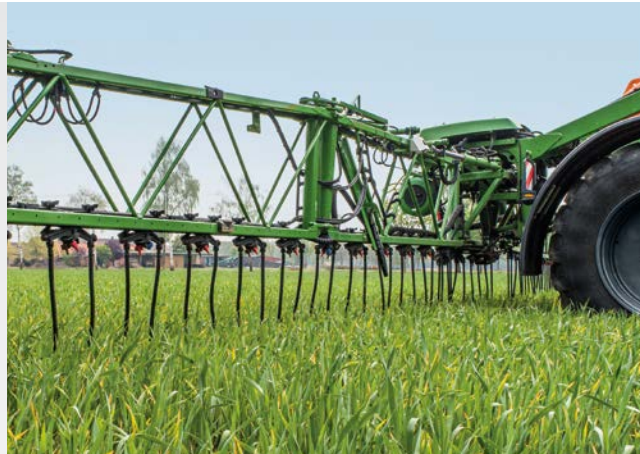
Équipement de pendillards avec AmaSwitch plus avec quadrijets et kit de décalage des buses sur une rampe Super-L2
