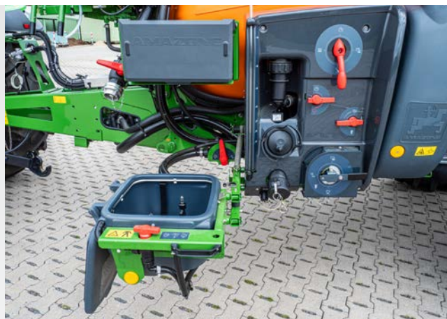
SmartCenter côté gauche de la machine avec bac incorporeur ouvert
