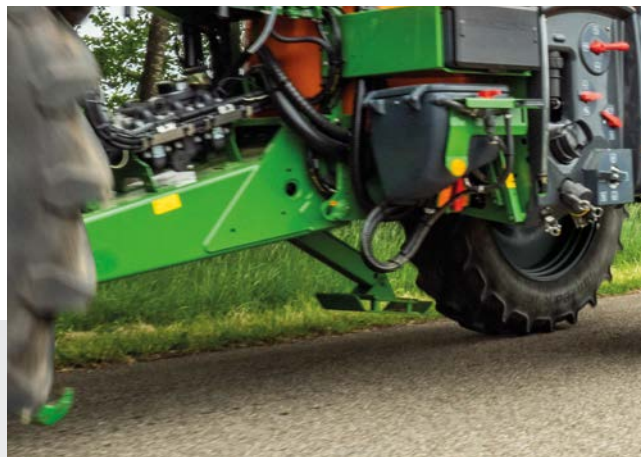
Attelage en position basse avec béquille hydraulique
