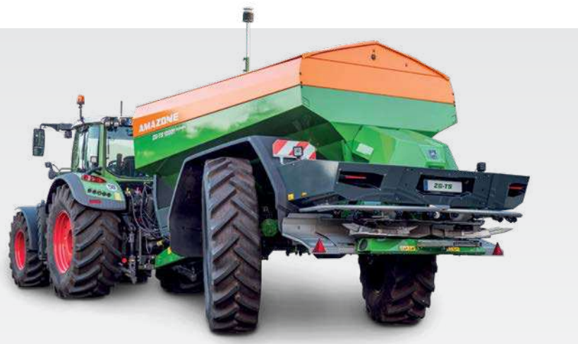
Gestuurde as met stuuruitslag tot 28 °
