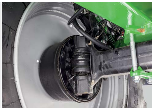
Remkrachtregeling door elektronisch remsysteem (EBS)
